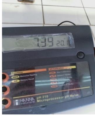
شكل(7):جهاز pH mètre .
